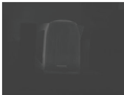
Рисунок 6. Тепловизионное изображение без применения АРУ
