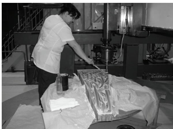
Рисунок 4. Финишная доводка матрицы
