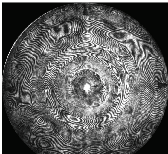
Рисунок 7. Интерферограмма волнового фронта после предварительной полировки поверхности зеркала
